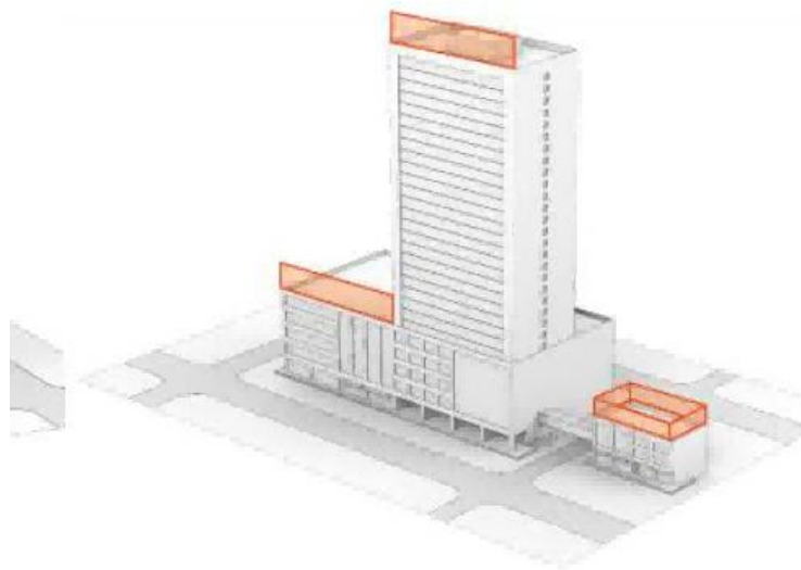
不推荐：广告招牌突破建筑轮廓线
