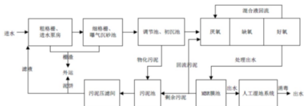
图 8. 鹤山工业城鹤城共和片区污水处理厂污水处理工艺流程图
