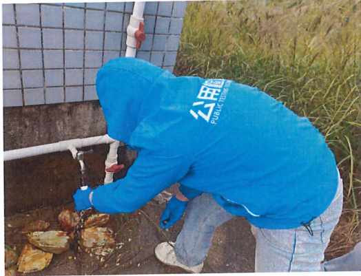
四堡水厂出厂水采样口
