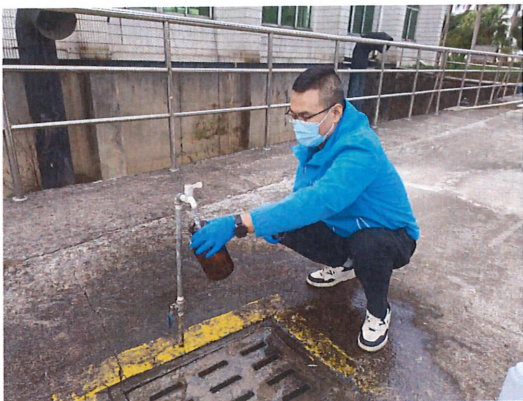
第二水厂出厂水采样口
