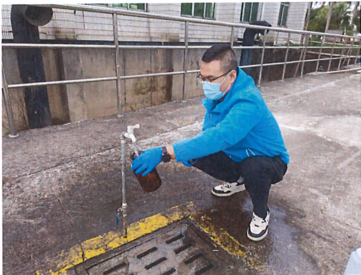
第二水厂出厂水采样口
