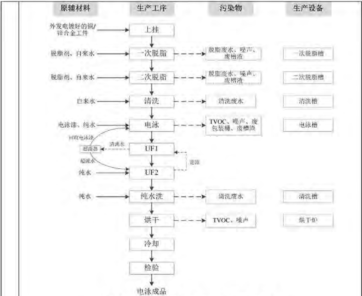
图2-16 电泳生产线工艺流程及产污节点图
