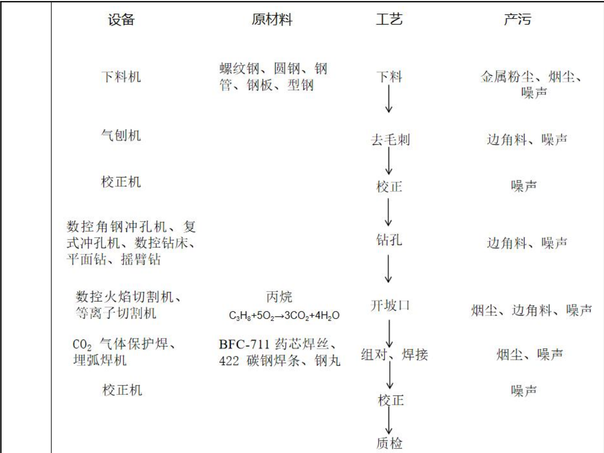
图2-3金属件生产工艺流程图
