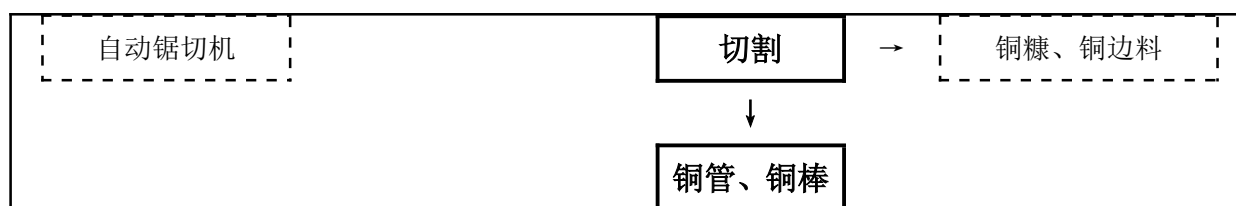
图 2-7 拉伸铜管、铜棒生产工艺流程 (厂房一、厂房四、老车间一)
