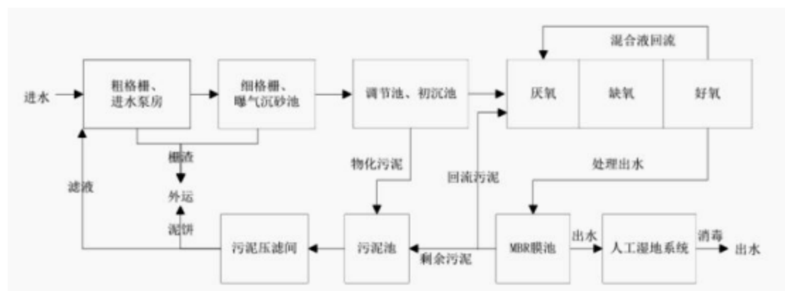
图 4-1 鹤山工业城鹤城共和片区污水处理厂工艺流程图
