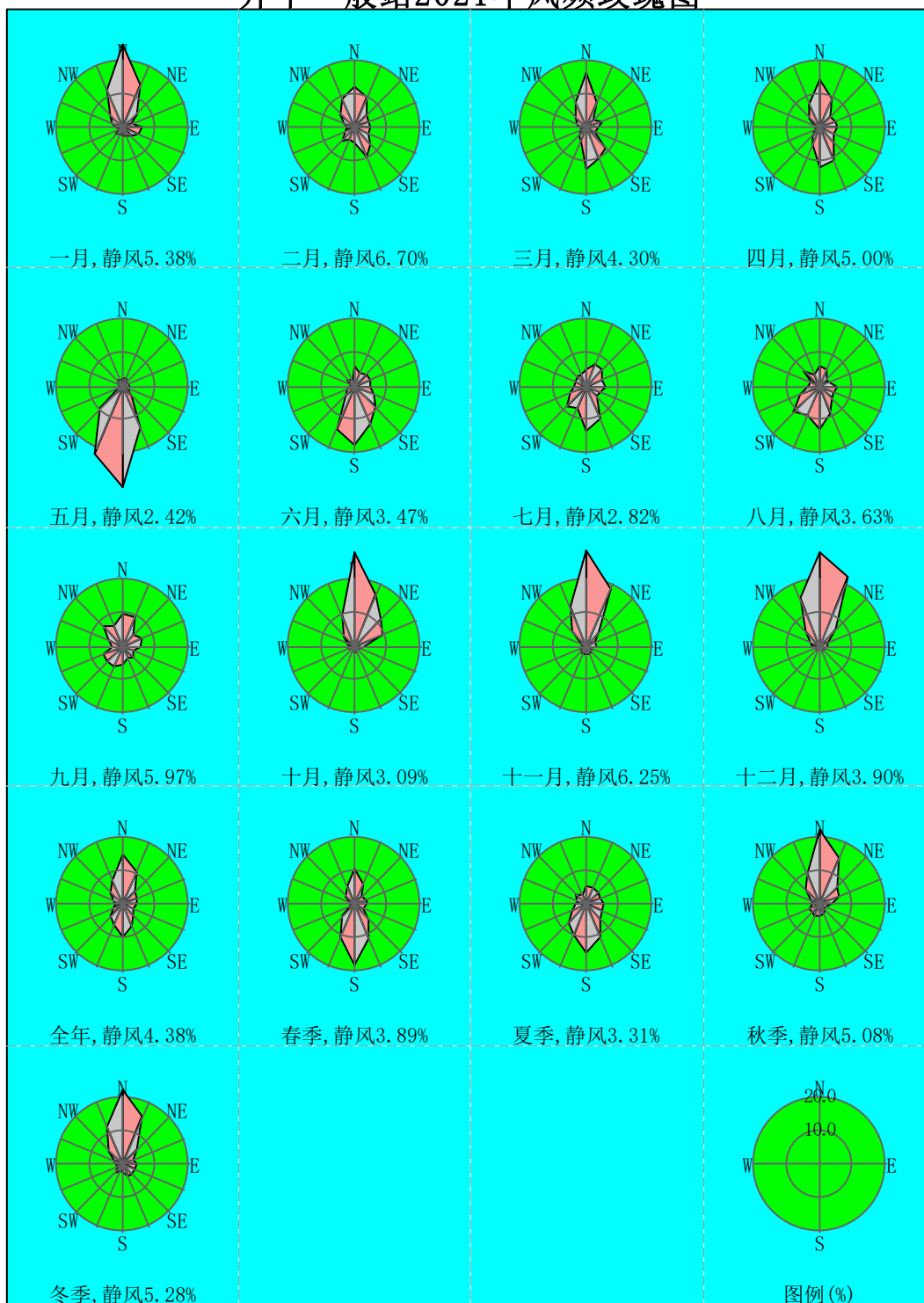
图 5-5 开平国家一般气象站各季及年平均风向玫瑰图 (统计年限: 2002-2021 年)
